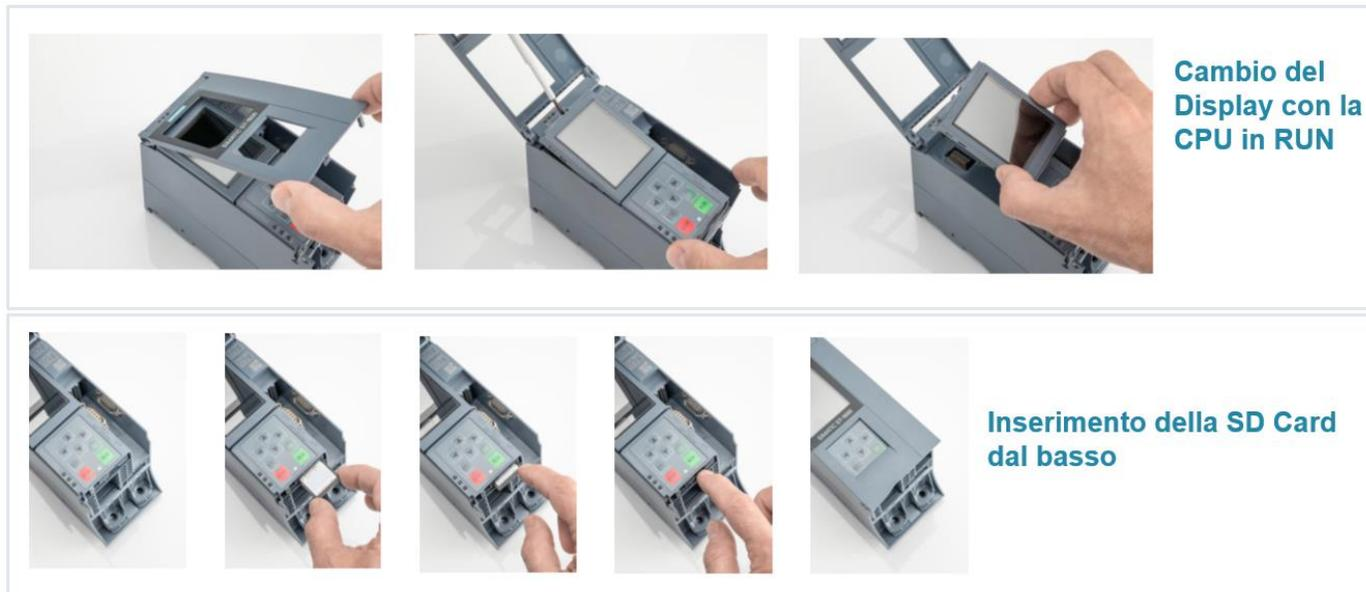
**Cambio del Display con la CPU in RUN**
